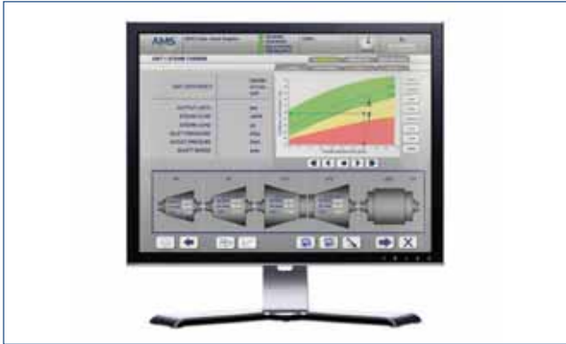
AMS Asset Graphic通过直观的图形化信息将停机保护，预测分析和性能监测详细参数集成在同一个界面上。
