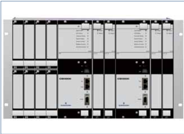
当停机保护系统已经存在，或者不需要停机保护系统时，CSI 6500可以配置为纯粹的预测分析系统。当配置为后面板接线时，CSI 6500可以接受多达48路振动信号输入。
