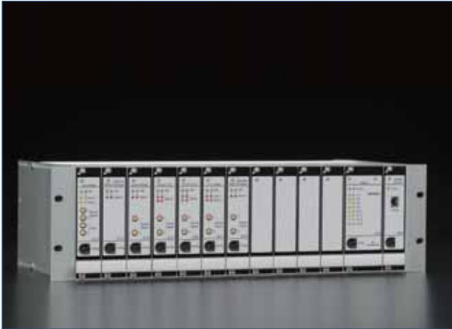
当CSI 6500只用于保护跳机并且安装空间有限时可使用 3U 框架。
